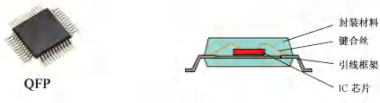
图 B.2 典型的集成电路及其封装型式
